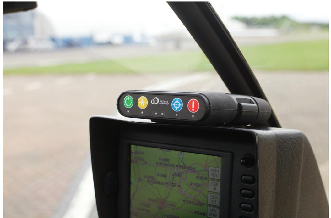
Si no es posible colocar el RockAIR en ningún lugar donde tenga tal visibilidad, deberá instalar antenas externas. Esto suele consistir en antenas de modo dual GPS/Iridium y una antena de telefonía móvil separada. Si este es el caso, deberá notificarlo al momento de la compra, o devolver el equipo al distribuidor para que autorice la modificación.
